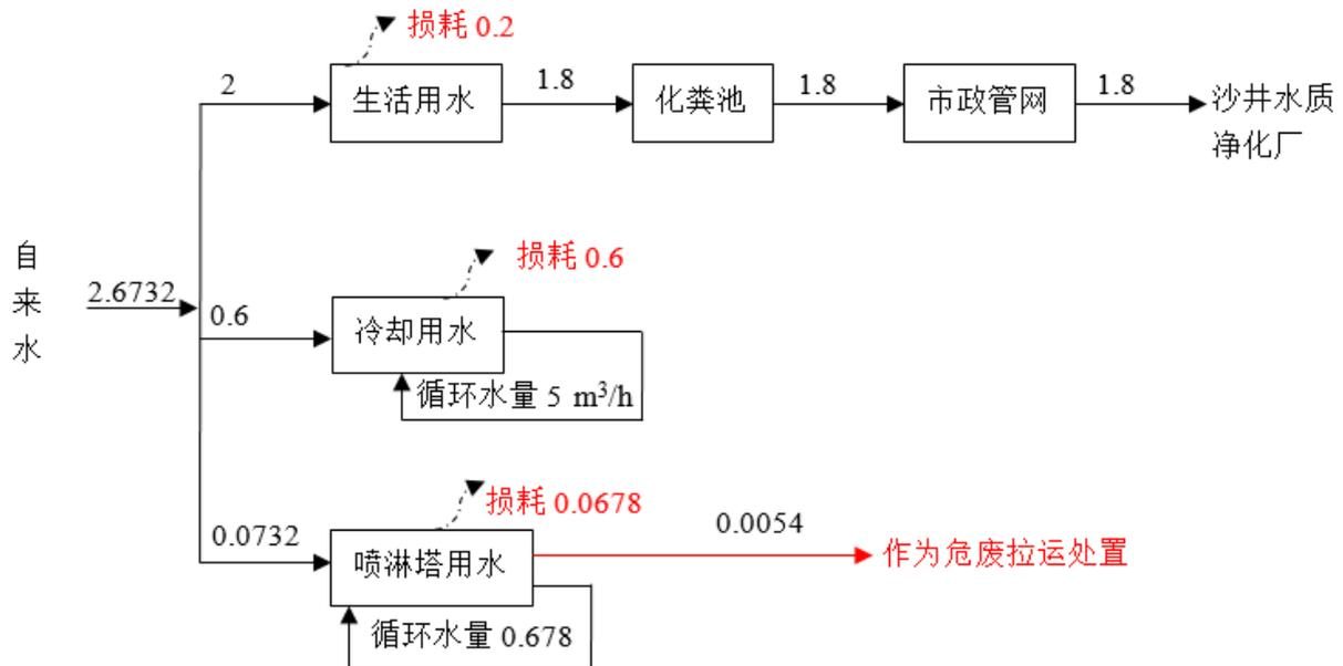
图 2-1 项目水平衡图如下 (m<sup>3</sup>/d)
